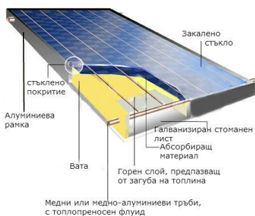
Фигура 8.Схема на плосък слънчев колектор и монтаж
